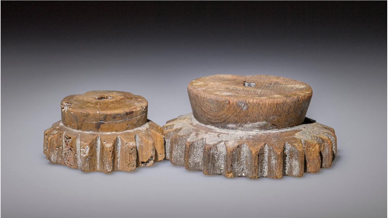
Fig. 6. S. Nicoletto. Ingranaggi lignei (Foto di Mirco Cusin).
