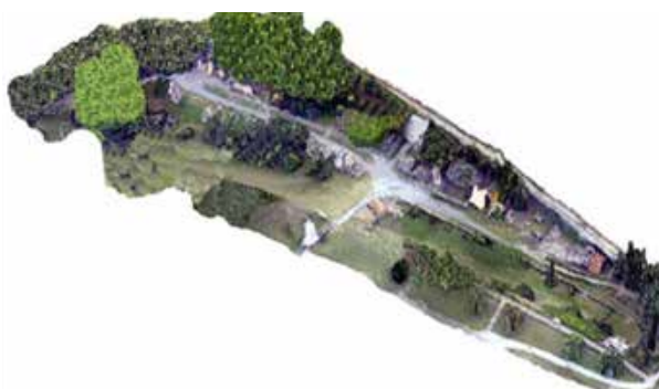
Fig. 4. Pompei. Necropoli di Porta Nocera. Ortofoto sovrapposta al modello digitale del terreno.
