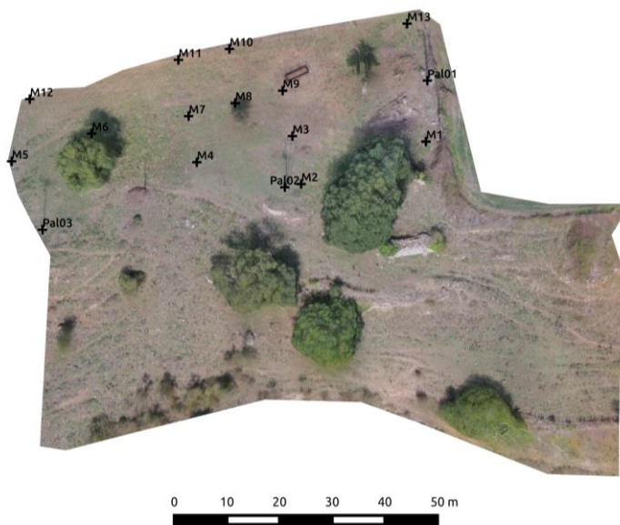
Fig. 4: Area 3, ortofoto realizzata tramite Structure from Motion e relativi target utilizzati
