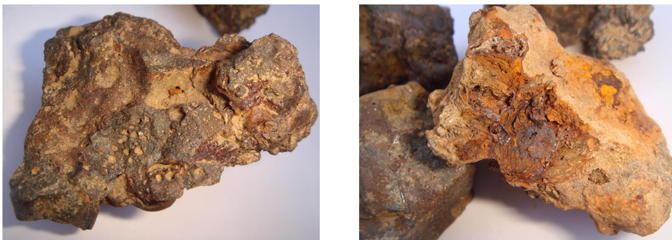
Figg. 16-17. Scoria di lavorazione del ferro allo stato di rinvenimento e sezionata per le analisi in laboratorio.
