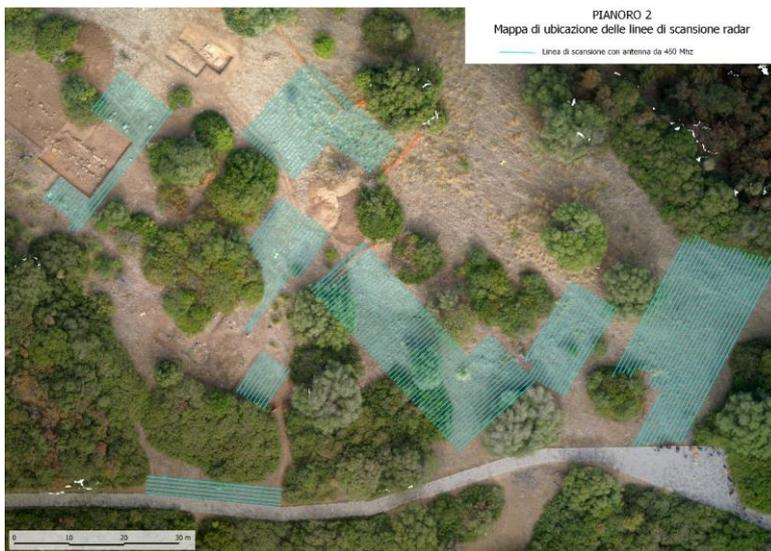
Fig. 18. Ubicazione delle linee di scansione mediante georadar (antenna da 450 Mhz).
