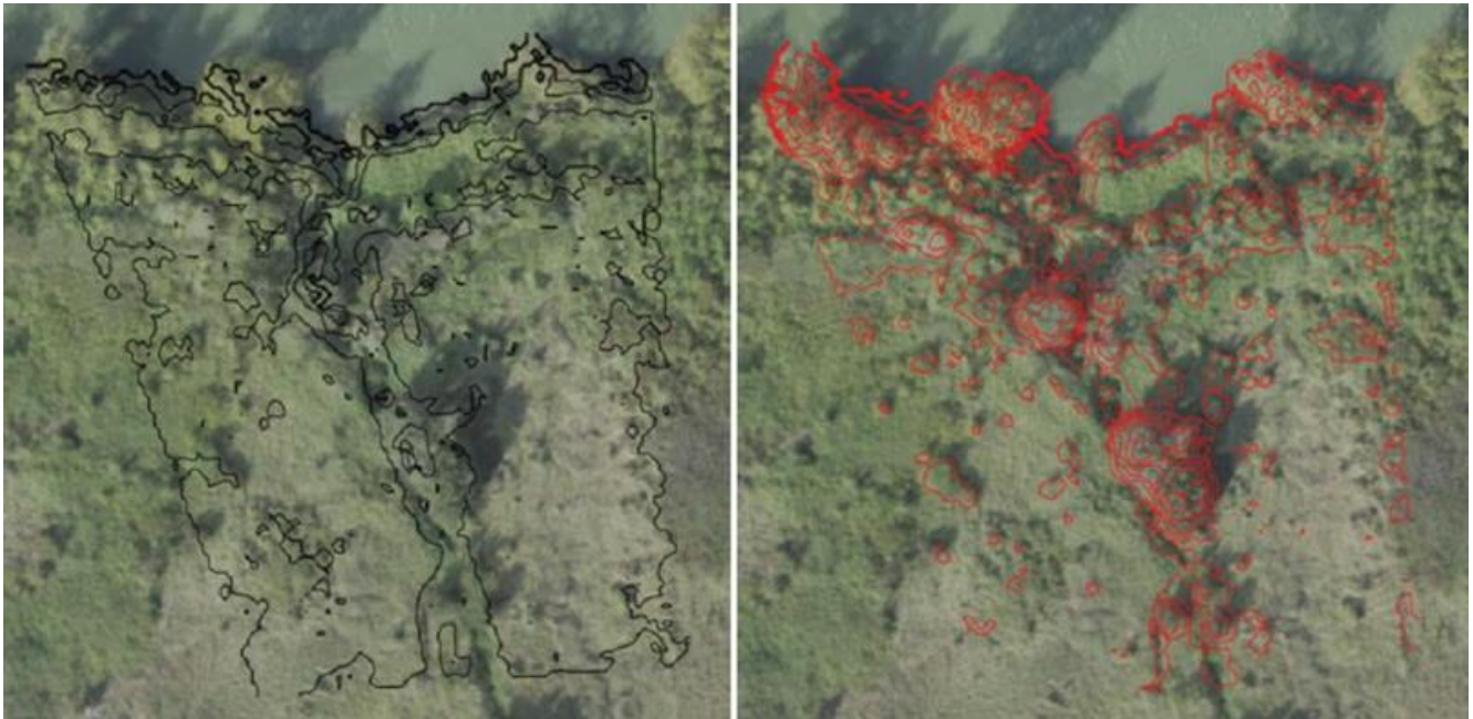
Fig. 18. Curve di livello a distanza di 2m estratte dal DTM e dal DSM (a cura di M. Balsi).
