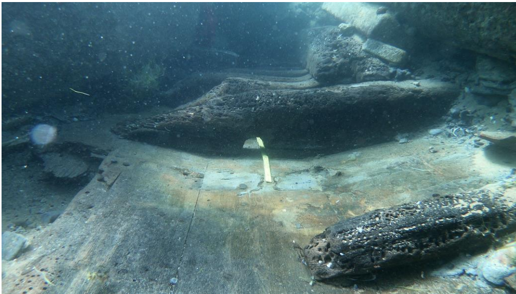
Fig. 11. Relitto delle Colonne: alcuni dei maderi preservatisi in cui è osservabile il foro di biscia unico e centrale in corrispondenza della sottostante chiglia (foto Massimo Capulli).
