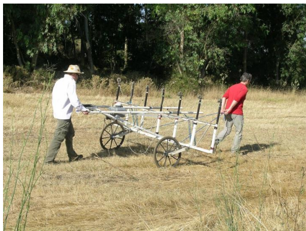
Fig. 4. GPR survey underway in Su Padrigheddu.
